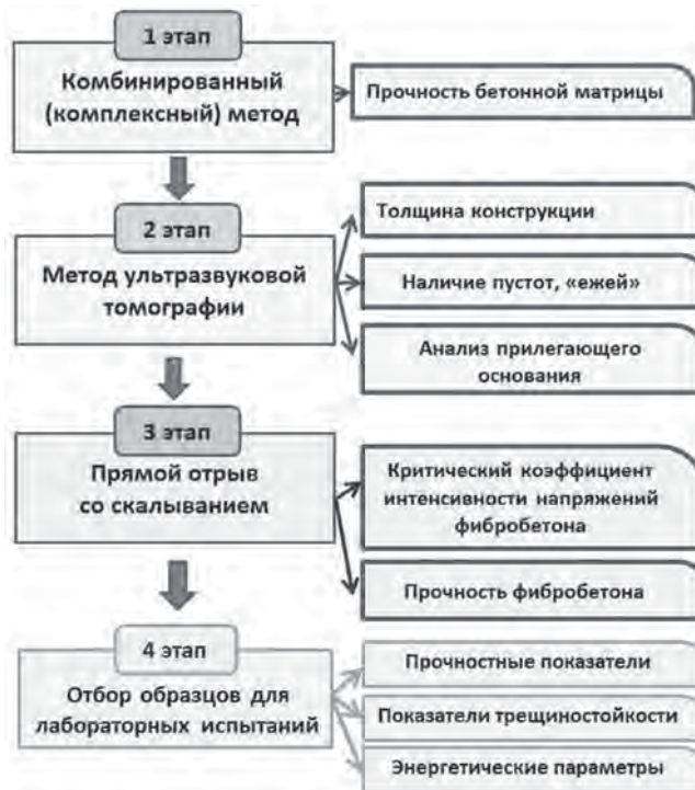
Рис. 1. Блок-схема методики контроля качества наноприбетонной конструкции
